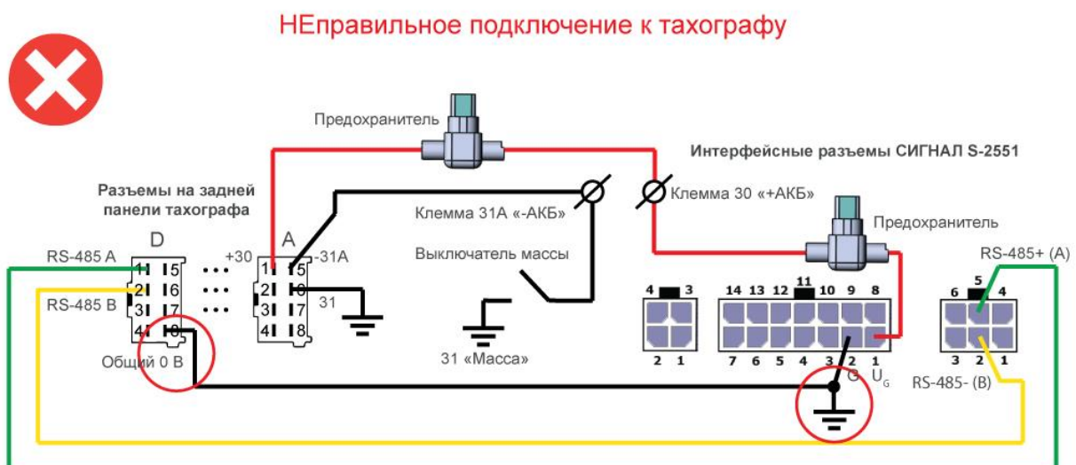
Рис. 1. Как нельзя осуществлять подключение к тахографу
